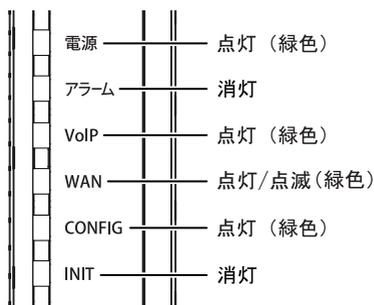
電源ランプが点灯し、INIT ランプとアラームランプが消灯していれば、本商品は正常に動作しています。
