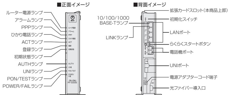
**ひかり電話対応機器 (PR-S300NE/SE/HI) 基本接続例**
