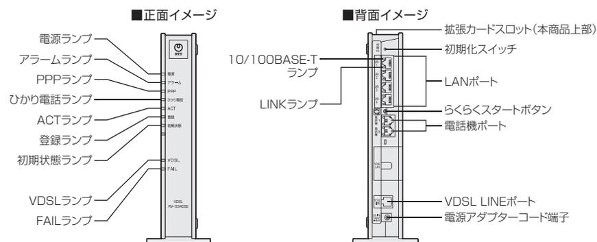
**ひかり電話対応機器 (RV-S340NE/SE/HI) 基本接続例**
