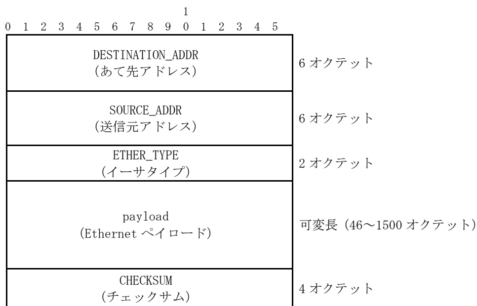
図 6.1 Ethernet フレームのフォーマット
